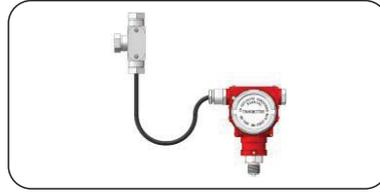
为了避免液体沿电缆流淌, 造成防水接头处积液或进入接线盒, 在穿线盒与液位变送器间应按图中所示, 配置成U型环状, 并使U型底部低于压力变送器接线盒。并考虑维修更换需要, 预留足够长度的电缆。
