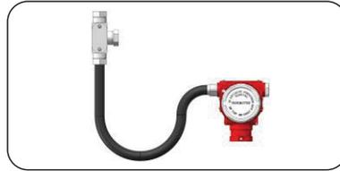
⚠️在危险场合安装使用防爆型压力变送器, 应使用金属挠爆管把信号电缆连接到穿线盒, 并引到安全区域。
