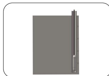
压力变送器应整体安装在保护套管内，避免快速流动介质对压力变送器造成冲击。
